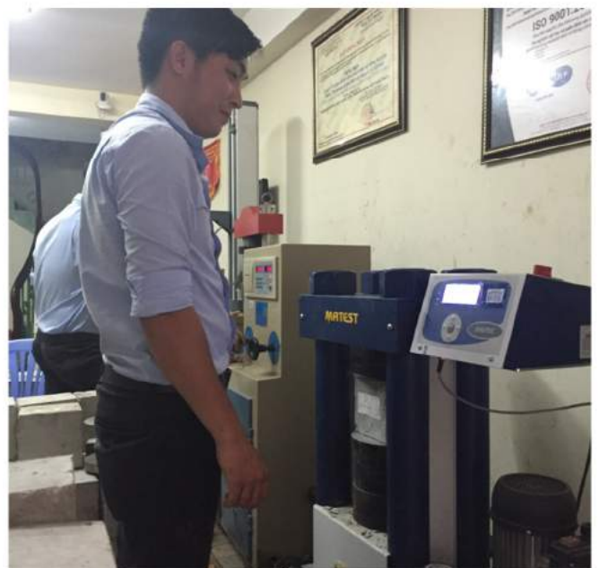
THÍ NGHIỆM NÉN BÊ TÔNG
