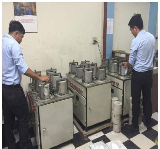
THỬ ĐỘ THẨM NƯỚC CỦA BÊ TÔNG
