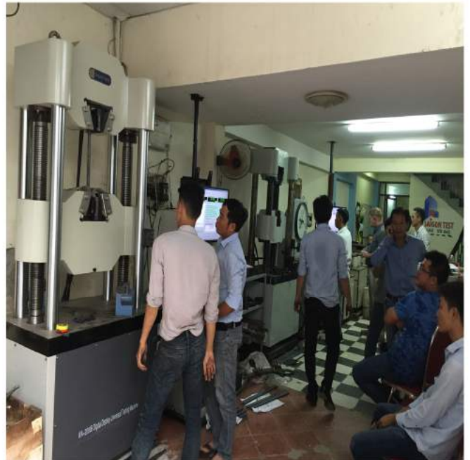
THÍ NGHIỆM KÉO THÉP – MÁY 2000 kN
